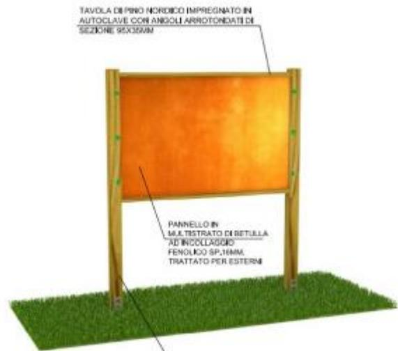
TAVOLA DI PINO NORDICO IMPREGNATO IN AUTOCLAVE CON ANGOLI ARROTONDATI DI SEZIONE 95X36MM
