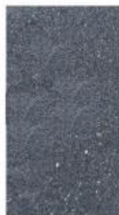
Cemento con inertes in pietra lavica.
